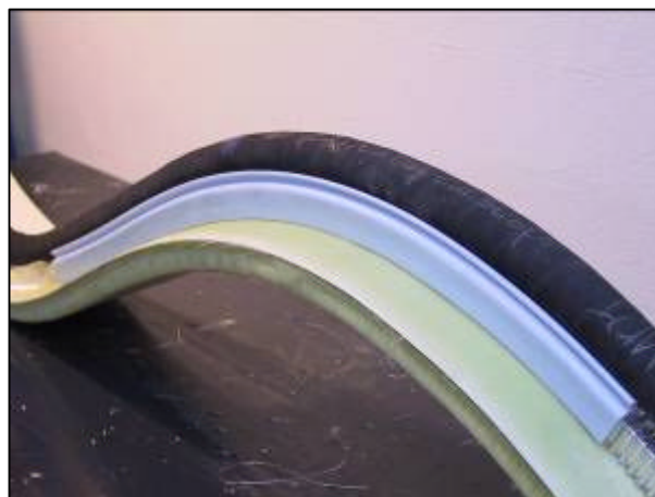
Profil og laminat fikseres ved hjælp af fleksibelt lod (f.eks. FlexLoad™ fra MDT)
