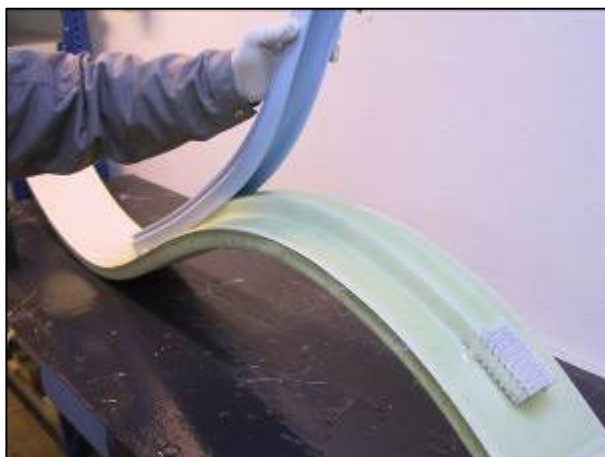
Profilet placeres oven på det løst placerede laminat.
