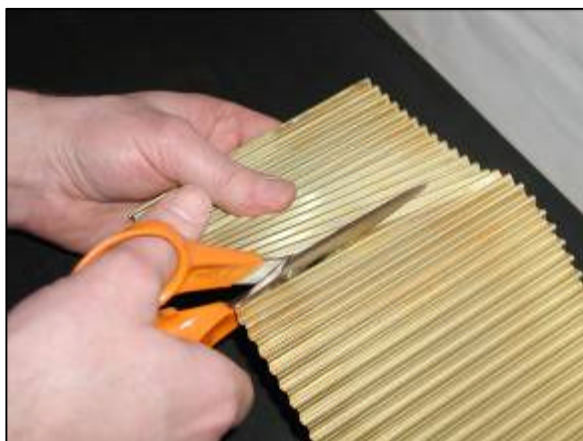
Die gewellte Folien kann mit einer gewöhnlichen Schere geschnitten werden
