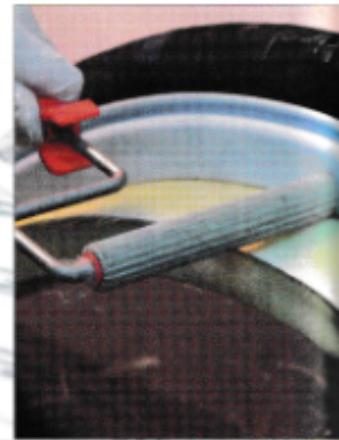
Afluttende konsolidering efter overlaminering. Flextool™ (lyseblå) nederst og Flexload™ (sort) øverst.
